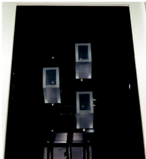
Рисунок 5 - Установка кювет в шахматном порядке.
